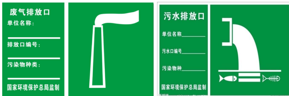
图 9.2-1 规范化废气及废水排放口标志牌
