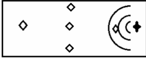
图 4.3.5-3 测量背景噪声和声场分布的实验布置图
