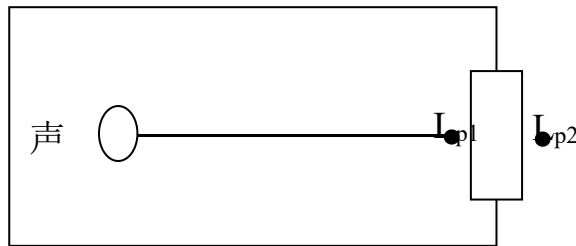
图 7.4-1 室内声源等效为室外声源图例
